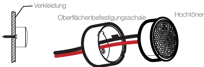
Abb. 4 Einbau auf der Oberfläche
