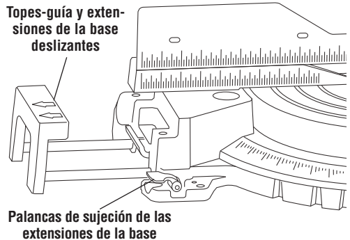
Figura 25. Topes-guía y extensiones de la base deslizantes
