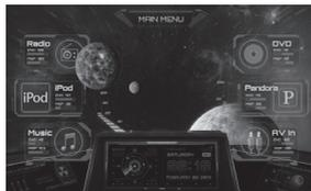
La pantalla UltraMotion™ permite al usuario personalizar la disposición del Menú principal reacomodando los íconos de modo a la izquierda o a la derecha de la pantalla. Seleccionar un modo del menú de desplazamiento en el medio de la pantalla, mantener presionado durante 2-3 segundos, luego arrastrar hacia la ubicación deseada y soltar.
